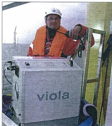
Auf der Plattform der Windkraftanlage ist wenig Platz. Die Kabelprüfung mit 0,1 Hz zahlt sich hier doppelt aus, denn das Gerät für die VLF-Prüfung ist klein und leicht, wie Christian Wenzel (Bild) berichtet.
